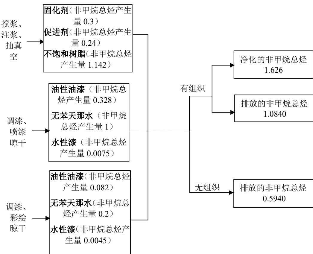
图 2-2 非甲烷总烃物料平衡图 (t/a)
