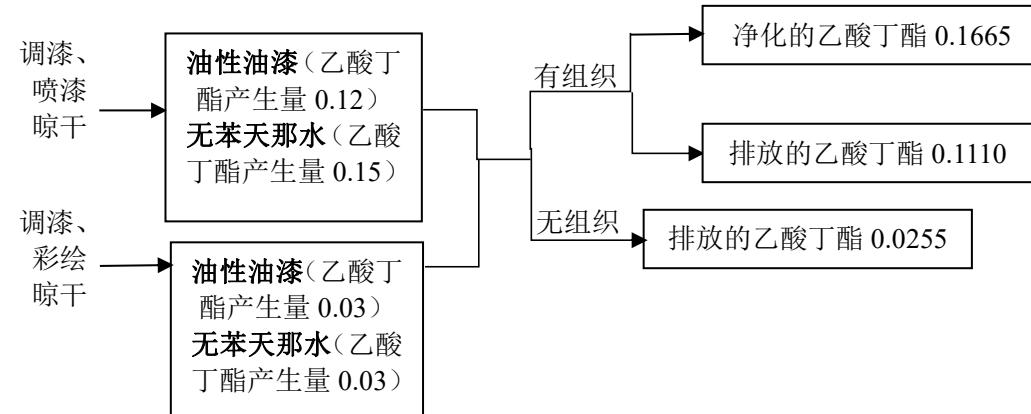
图 2-4 乙酸丁酯物料平衡图 (t/a)
