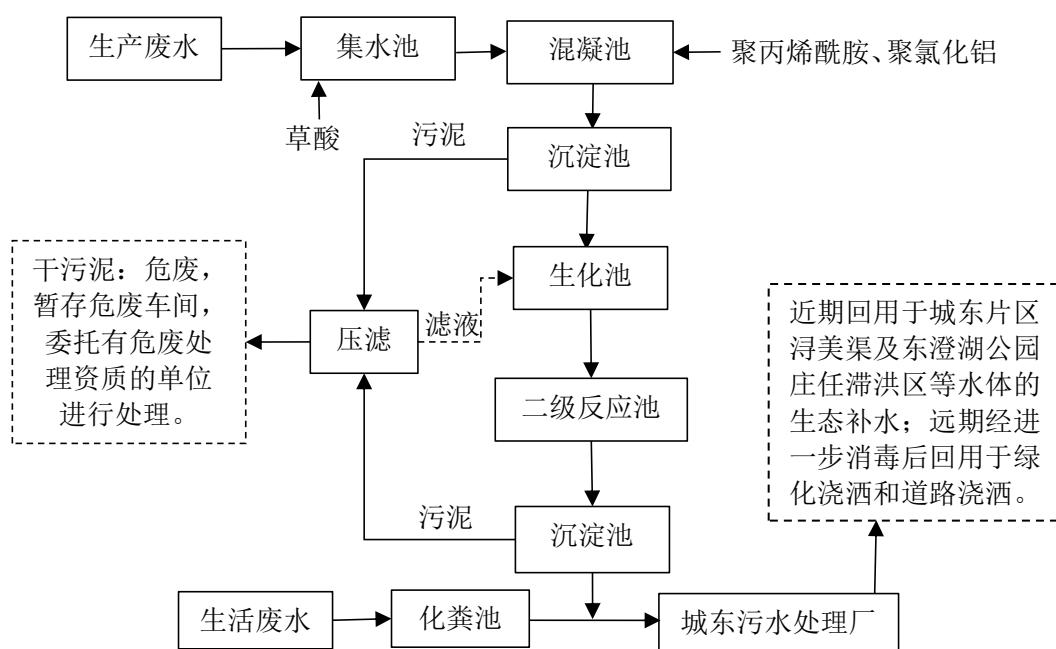
图 4-1 生产废水处理设施工艺流程图
