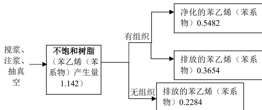
图 2-3 苯乙烯物料平衡图 (t/a)
