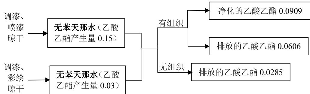
图 2-5 乙酸乙酯物料平衡图 (t/a)
