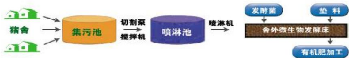
图 2.3-8 异位发酵床发酵处理工艺流程图
