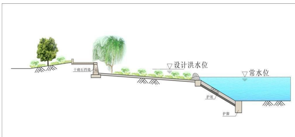
图 2-20 复合式-砌石护坡+生态护坡断面示意图
